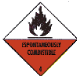
Class 4.2: Substances Liable to spontaneous combustion Clase 4.2: Substancias que prestan riesgo de combustión espontánea
