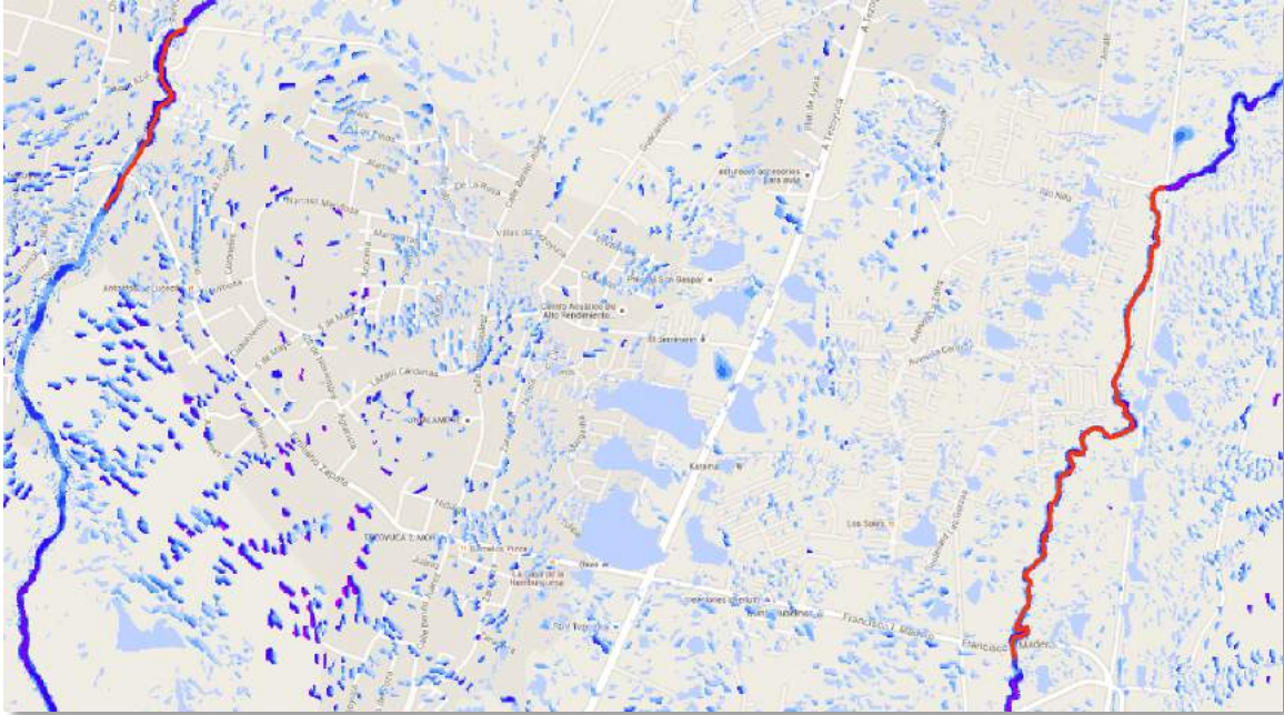
Figura 49. Comparación entre sitios de inundación de la CEA contra simulación hidráulica Tr2, Tezoyuca. Los sitios identificados por la CEA están marcados como líneas rojas.
