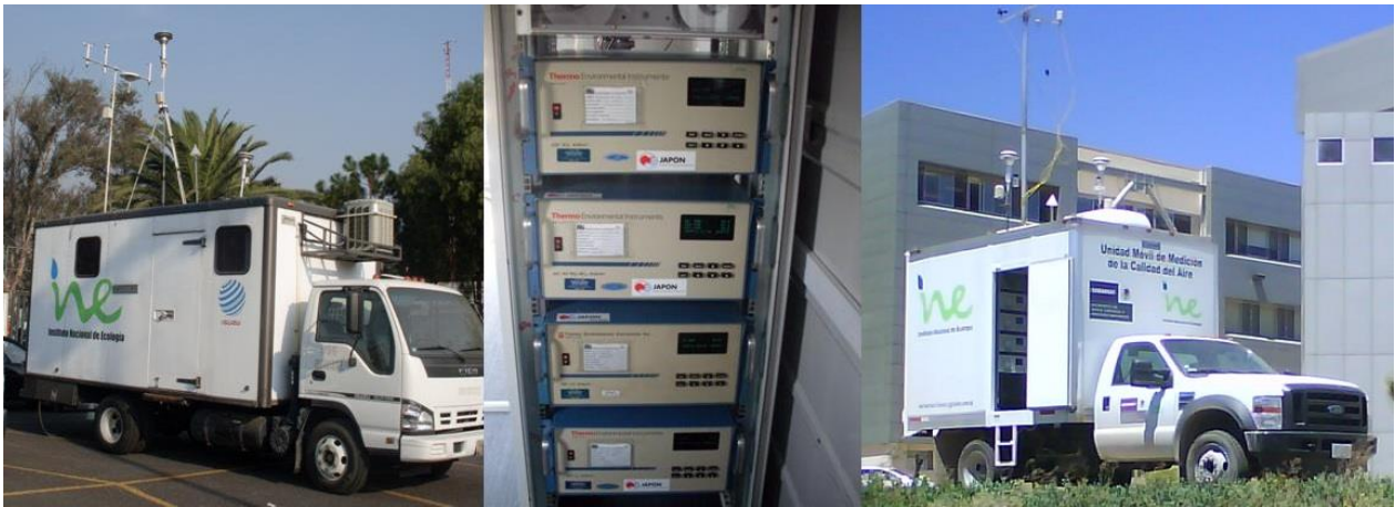
Figura 2 Unidades móviles, propiedad del INECC, que se utilizaron para el monitoreo de las emisiones del volcán Popocatépetl.
