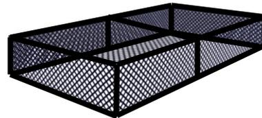
**DIMENSIONES:** Tiene forma rectangular con dimensiones de 1 m de ancho por 2 m de largo por 10 cm de alto, para una mejor maniobrabilidad dentro y fuera de la zona de cultivo.
