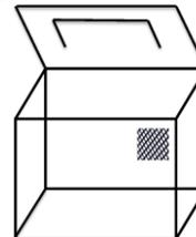
**DIMENSIONES:** Los marcos miden 1.80 m de ancho por 1.80 m de largo por 1.80 m de altura. La tapa o apertura, tiene 1.60 m de largo x 0.90 m de ancho.
