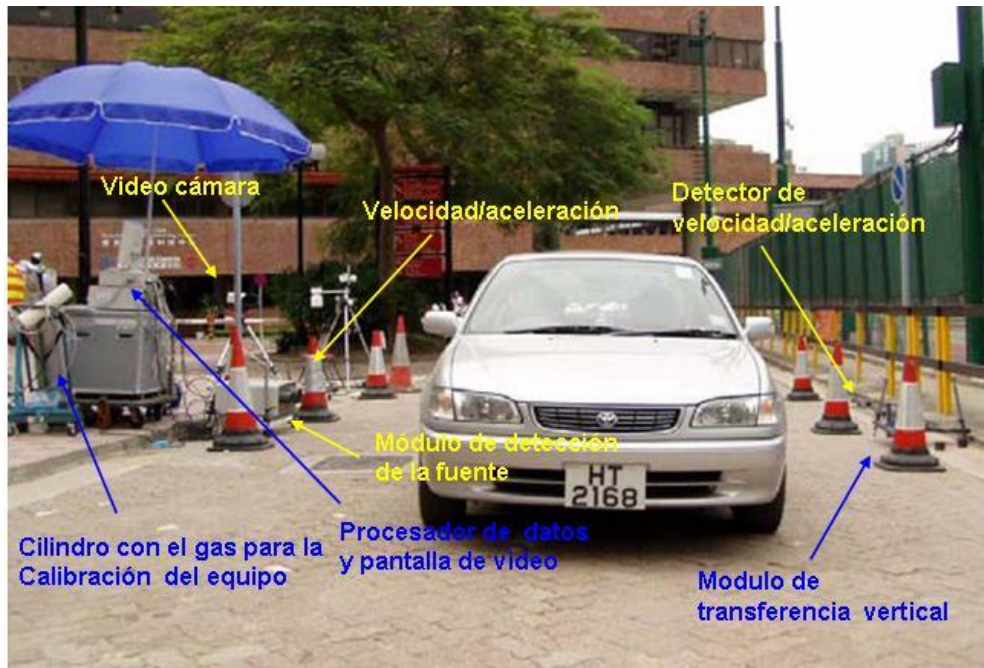
Figura 1.1 Arreglo típico del sistema de detección remota para medición de emisiones de vehículos en circulación (RSR, 2005)
