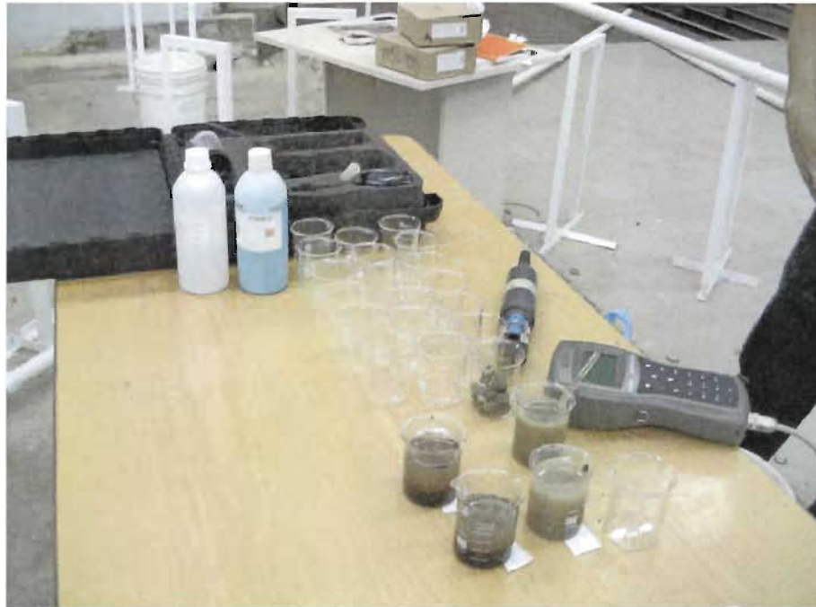
Figura 5.e. 28. Medición de salinidad, pH y OD de las muestras; pueden observarse los vasos con las muestras diluidas en agua destilada, el líquido azul para calibración de la sonda, el medidor y la sonda.
