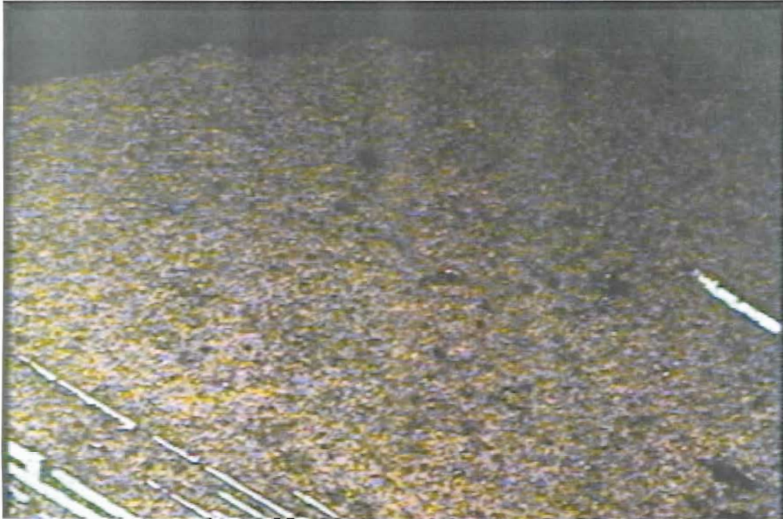
Figura 5.e. 45. Sondeo 34-GD (Villahermosa), muestra 10, prof: 5.7m., 25X, Arcilla con poca arena fina y oxidaciones.
