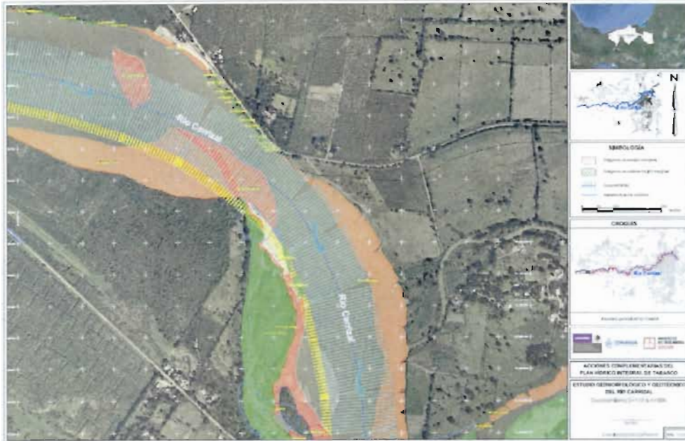
Figura 5.b.1. Ejemplo del análisis del corrimiento con las fotografías aéreas (anexo 5.b.1)
