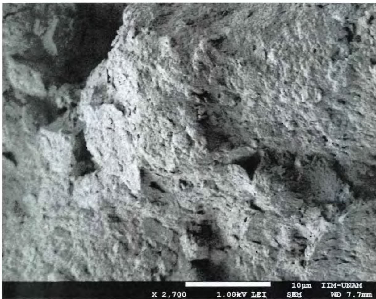
Figura 5.e. 60. Sondeo 19-CI (Villahermosa), muestra 21, prof: 12.3m. La escala gráfica de la parte inferior muestra una línea blanca que mide diez micras.
