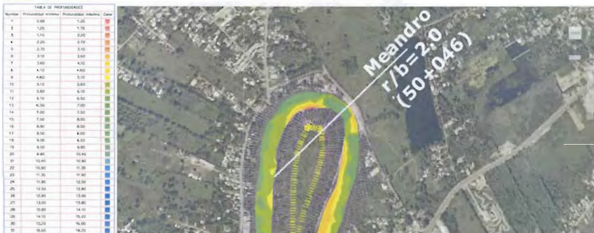
Figura 5.c.17. Cadenamiento 50+046, localización de un meandro con relación r/b=2.0
