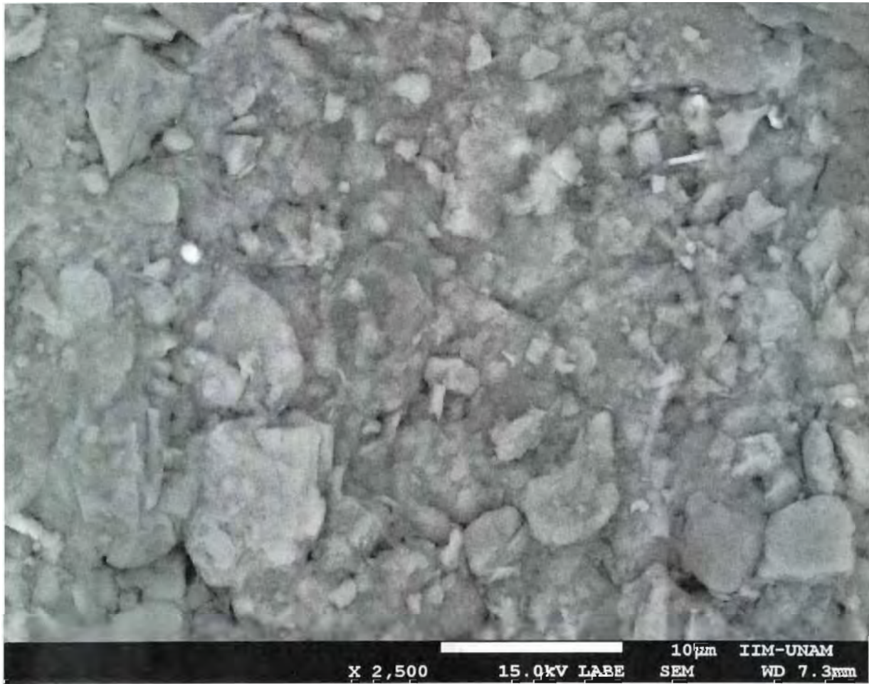
Figura 5.e. 62. Sondeo 06-CD (Villahermosa), muestra 13, prof: 07.5m. La escala gráfica de la parte inferior muestra una línea blanca que mide diez micras.
