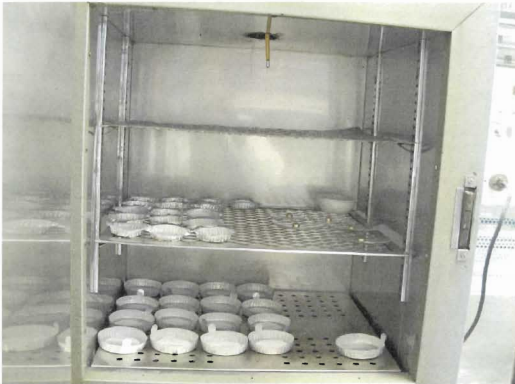
Figura 5.e. 31. Secado de muestras para determinación de fosfatos y de muestras para observación en el microscopio electrónico.
