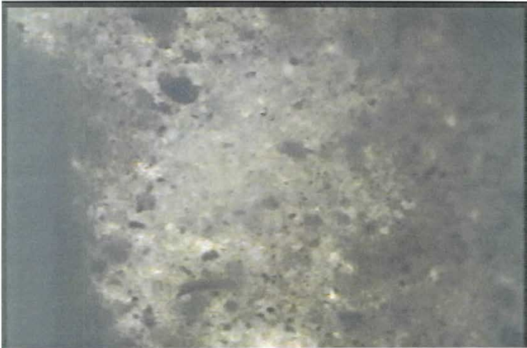
Figura 5.e. 43. Sondeo 27-CI (Villahermosa), muestra 09, prof: 5.1m., 100X, Arcilla poco limosa con escasa arena redondeada (calcita) y materia orgánica.
