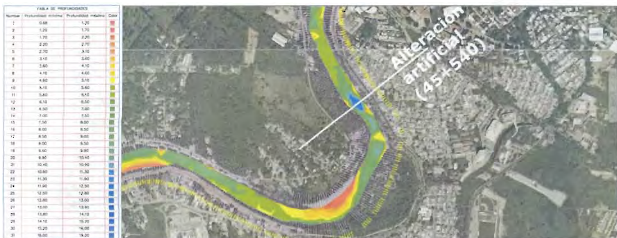
Figura 5.c.15. Cadenamiento 45+540, profundización después de una alteración artificial del río
