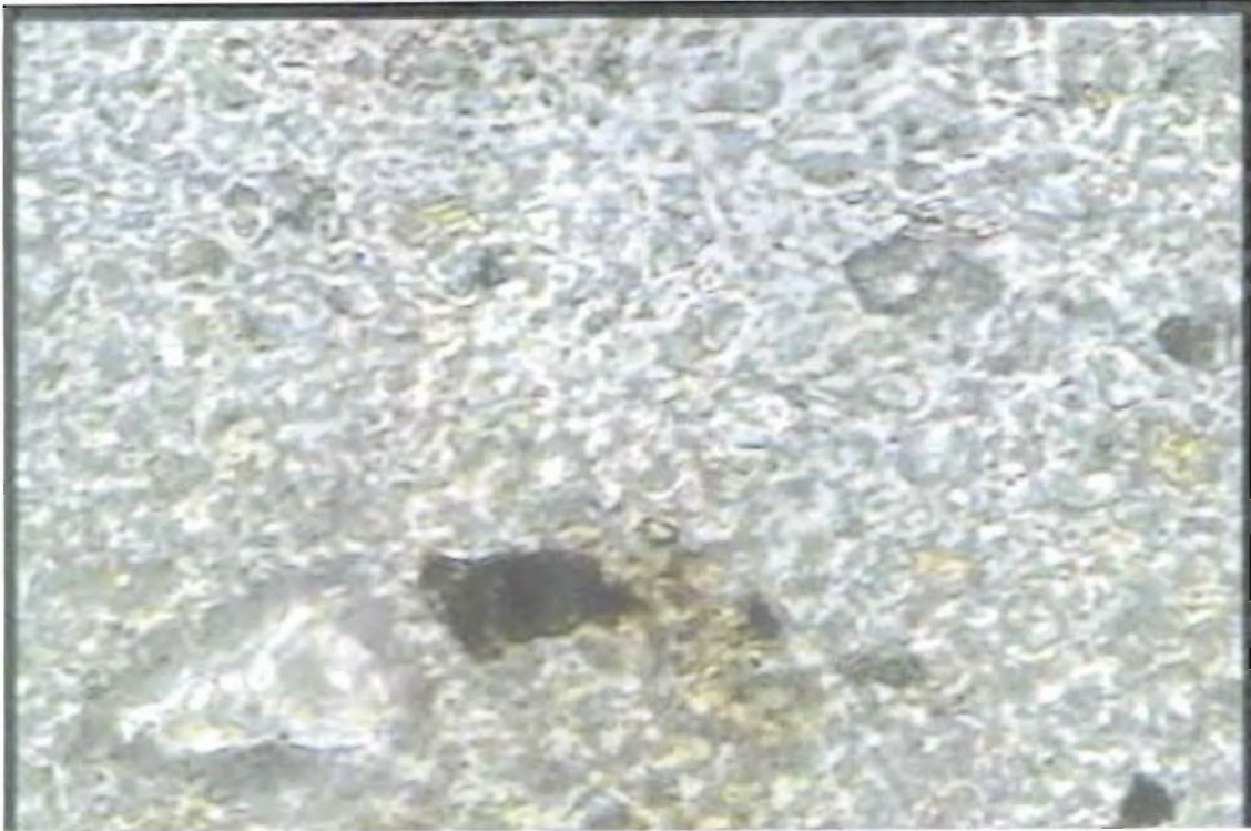
Figura 5.e. 50. Sondeo 02-CI (Villahermosa), muestra 07, prof: 4.5m., 100X, Limo con arena fina (calcita), fósiles, mica y materia orgánica.
