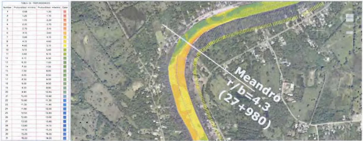
Figura 5.c.10. Cadenamiento 27+980, localización de un meandro con relación r/b=4.3
