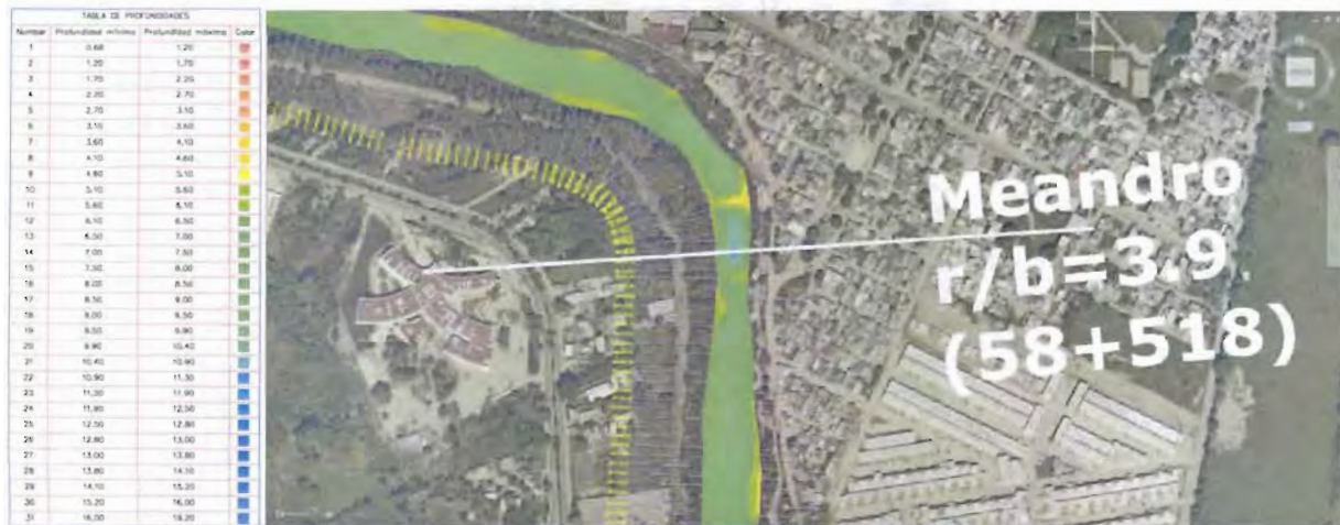
Figura 5.c.22 Cadenamiento 58+518, localización de un meandro con relación r/b=3.9
