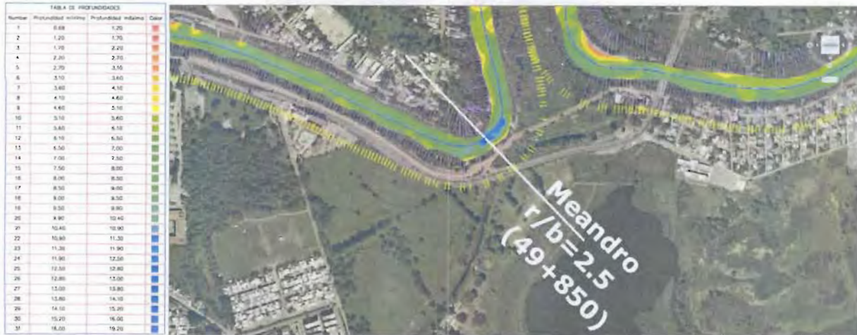
Figura 5.c.16. Cadenamiento 49+850, localización de un meandro con relación r/b=2.5
