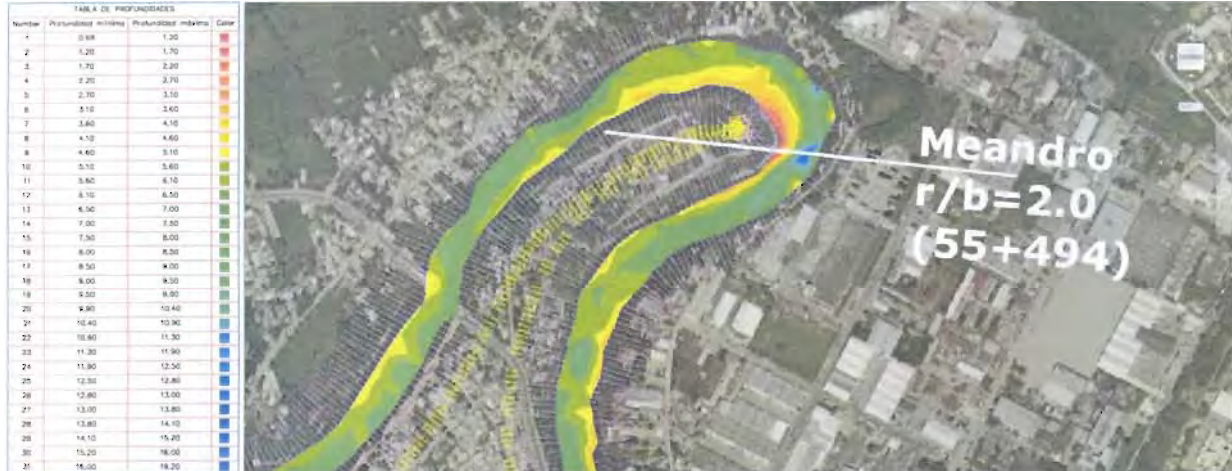
Figura 5.c.20. Cadenamiento 55+494, localización de un meandro con relación r/b=2.0
