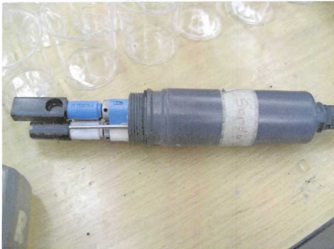
Figura 5.e. 30. Sonda del medidor multiparamétrico Hanna HI 9828 .
