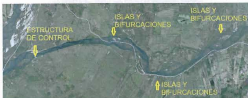
Figura 5.d.2 Zonas irregulares en el Cauce del Río Carrizal aguas abajo de la estructura de control El Macayo.
