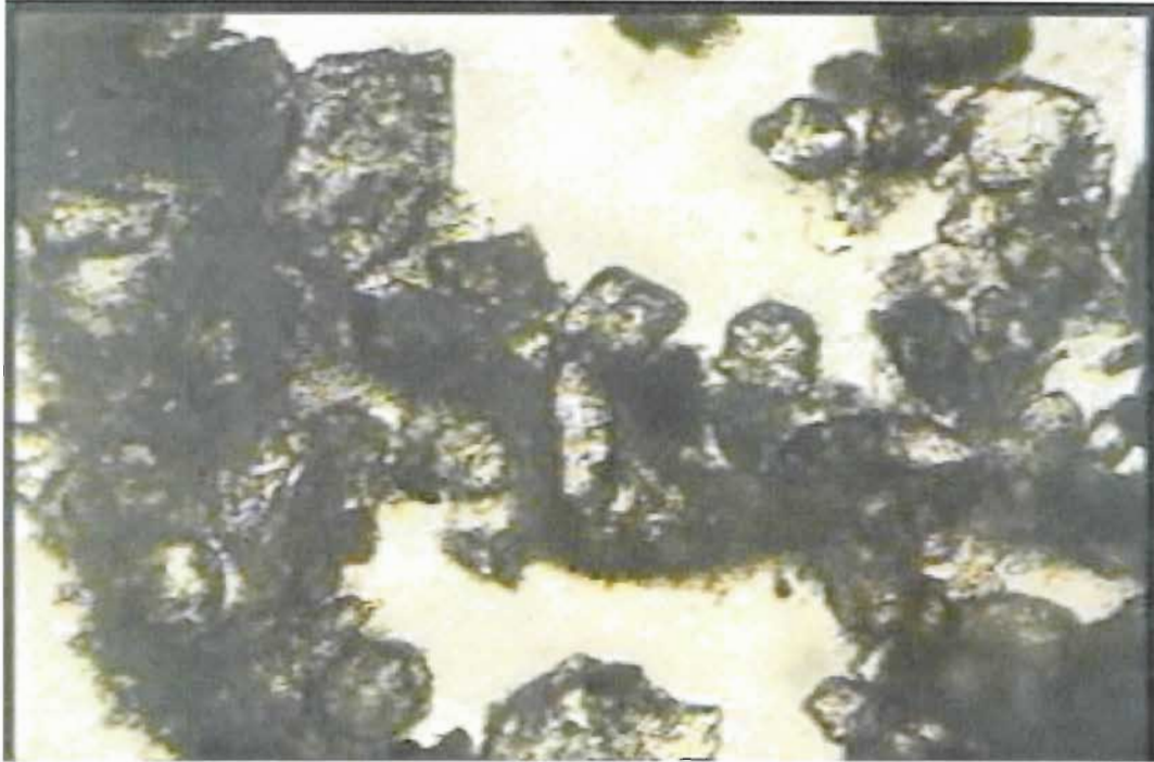
Figura 5.e. 35. Sondeo 19-CI, muestra 11, prof: 6.3m., 100X, Arena fina (calcita). de aristas redondeadas y otras angulosas, poco limosa, con mica y materia orgánica.
