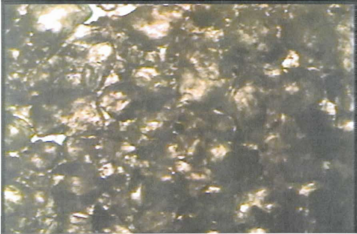
Figura 5.e. 38. Sondeo 46-UI (E. Zapata), muestra 10, prof: 5.7m., 25X, Arena fina (cuarzo) de aristas redondeadas, sin finos, con materia orgánica.
