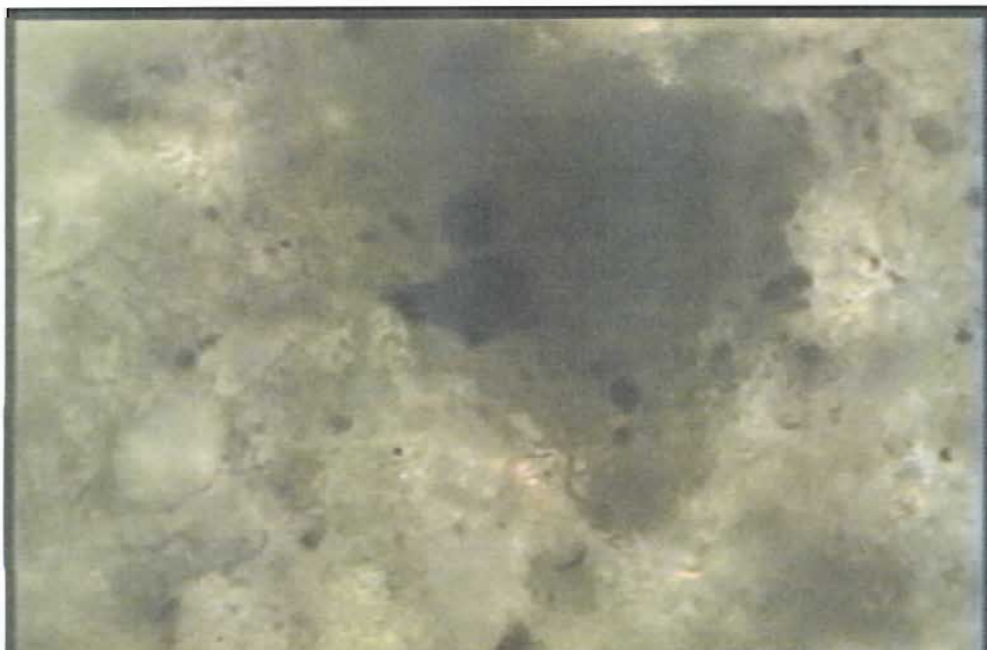
Figura 5.e. 44. Sondeo 27-CI (Villahermosa), muestra 09, prof: 5.1m., 400X, Arcilla poco limosa con escasa arena redondeada y materia orgánica.
