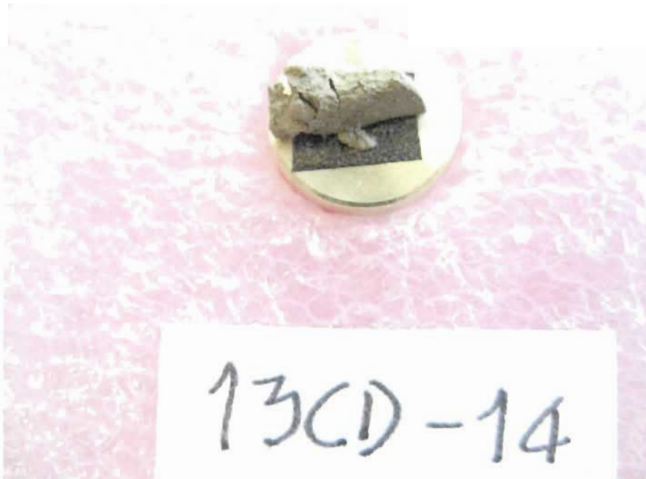
Figura 5.e. 54. Muestra 14 del sondeo 13CD, de la margen derecha del río Carrizal, lista para su observación en el microscopio electrónico.
