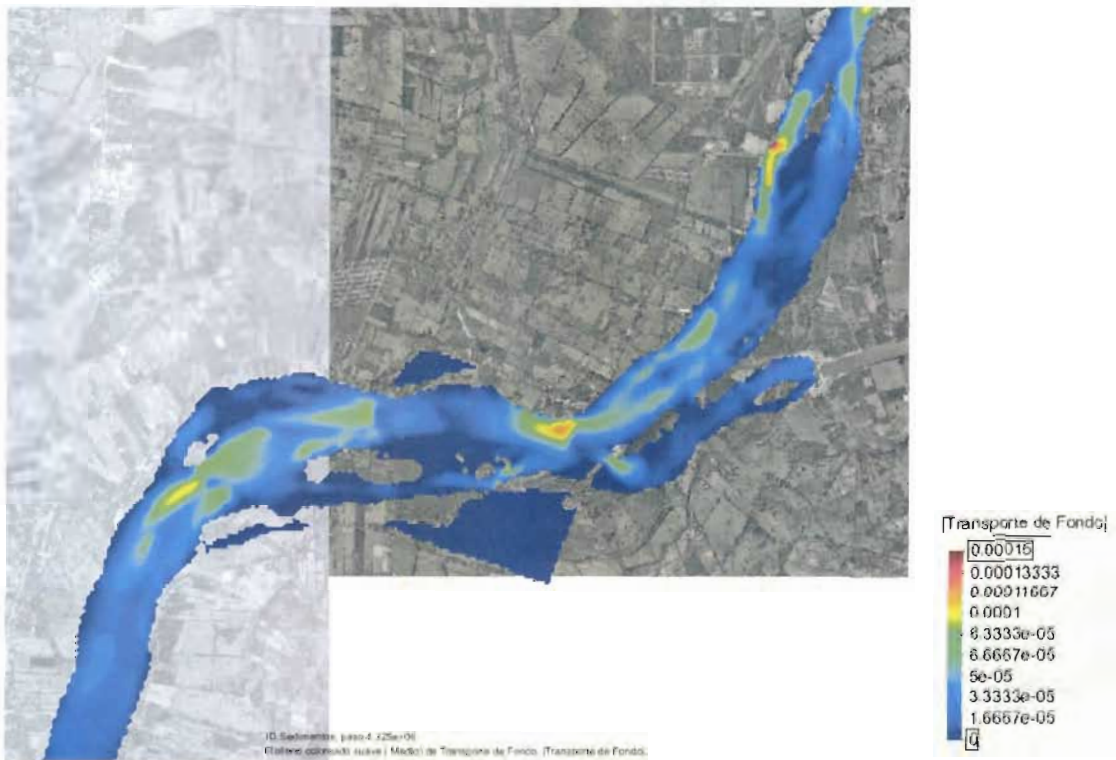
Figura 4.c.41. Transporte de fondo para el día 50 de simulación.
