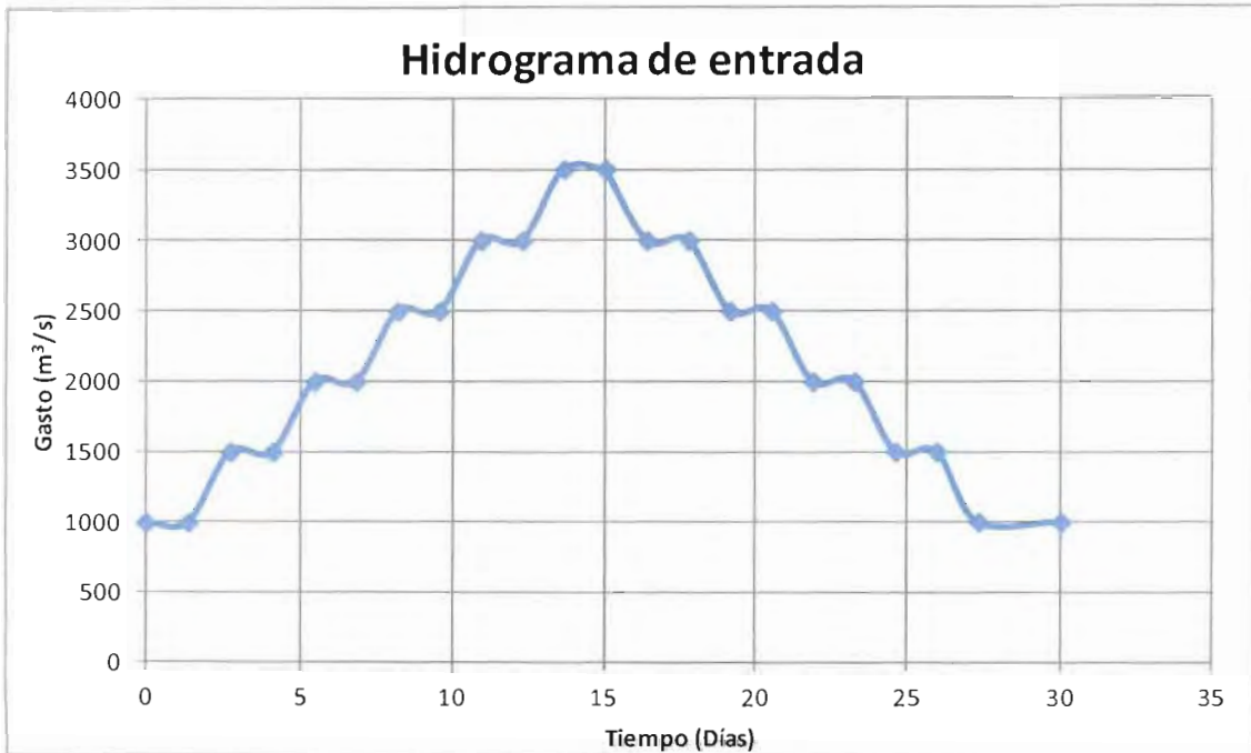
Figura 4.c.2. Hidrograma de entrada en la modelación preliminar de la bifurcación
