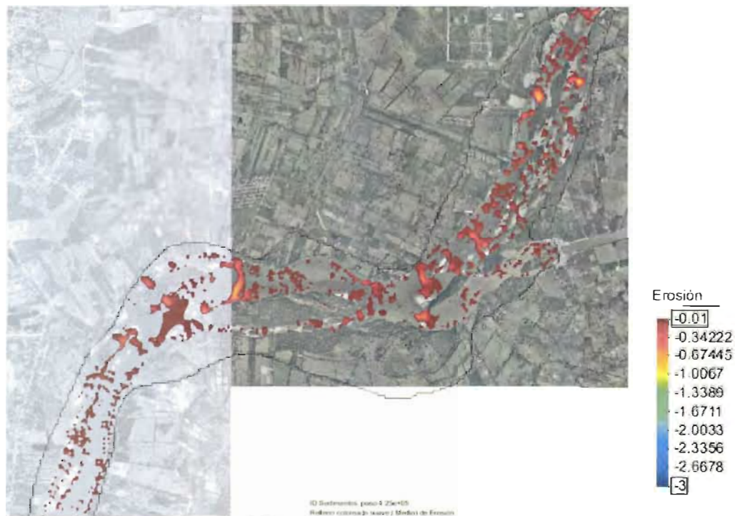
Figura 4.c.46. Zonas de depósito de sedimentos para 5 días. Resultados del modelo bidimensional. Iber v.1.7
