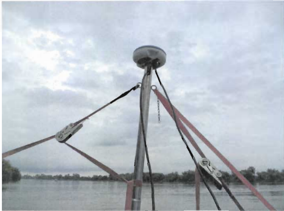
Figura 20. Fotografía del geoposicionador de la ecosonda durante los levantamientos batimétricos realizados en el municipio de Jonuta, por el río Usumacinta
