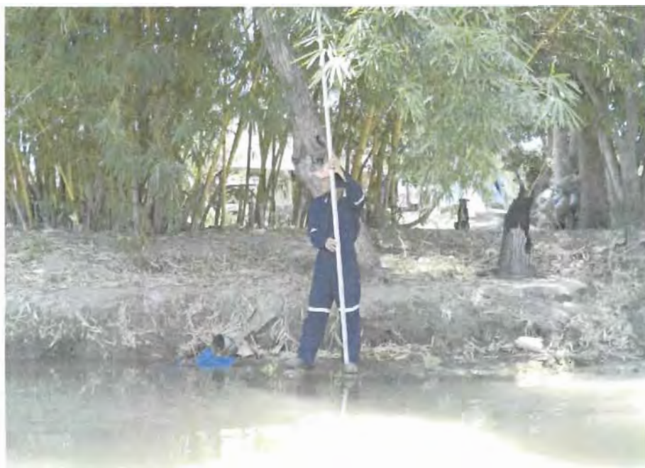
Figura 9. Lectura de la lámina del agua en la margen derecha del río Usumacinta
