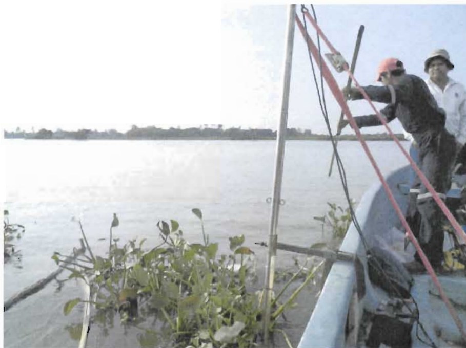
Figura 5. Verificación manual de la profundidad en los ríos con ayuda de un estadal.
