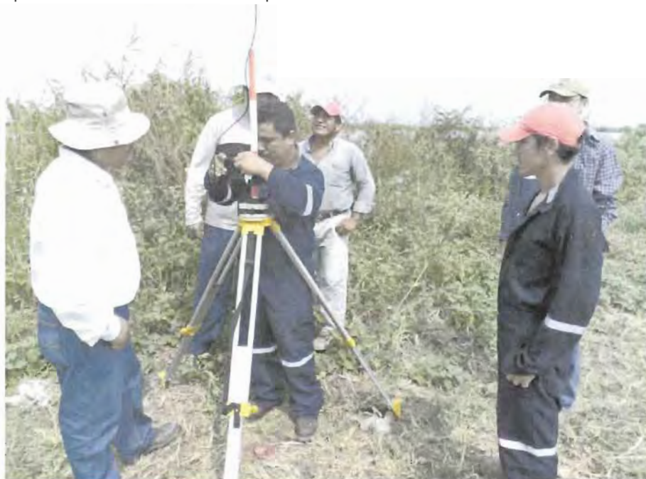
Figura 8. Colocación de GPS diferencial en la margen izquierda del río Chilapa
