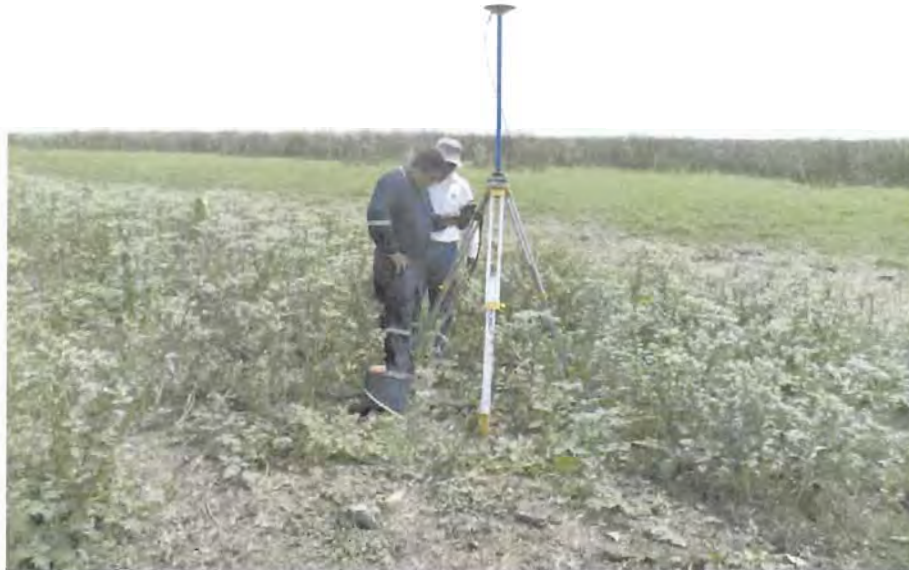
Figura 2. GPS diferencial utilizado en los levantamientos topográficos
