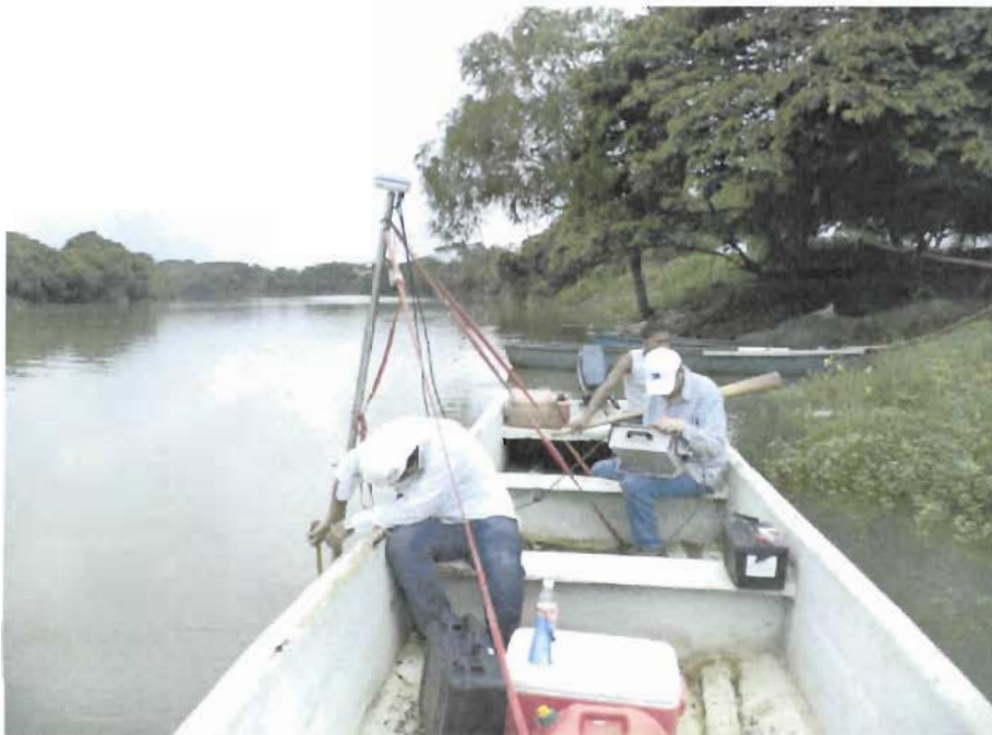
Figura 15. Levantamientos batimétricos y lectura del calado en el río Puxcatán
