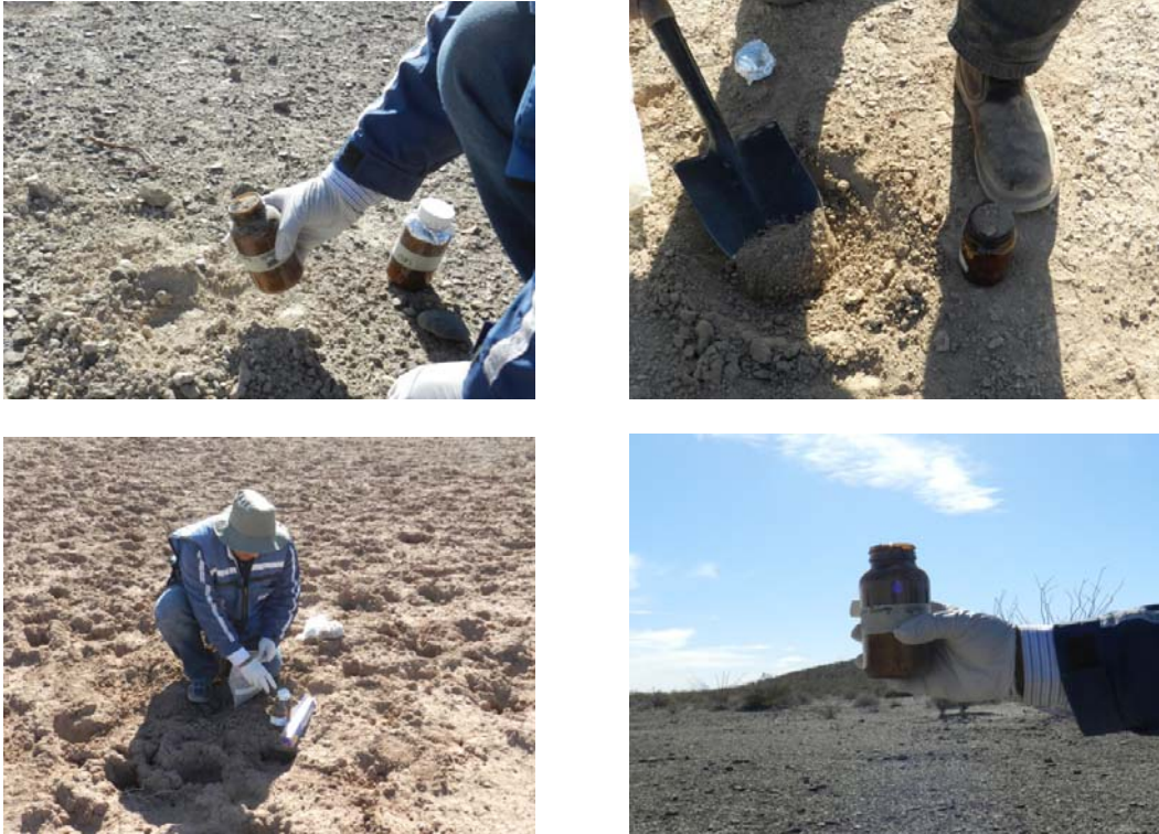
Figura 7.- Obtención de muestras de suelo para la determinación de COP y HAP
