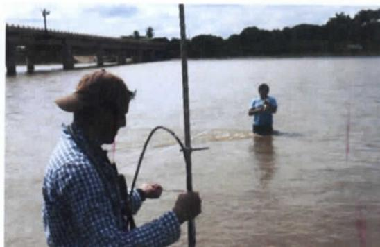
**Figura 12.4.91. Aforo con molinete Hidrométrico**
