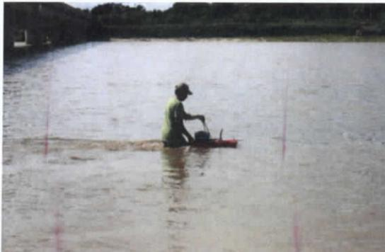
**Figura 12.4.90. Aforo con equipo Doppler**
