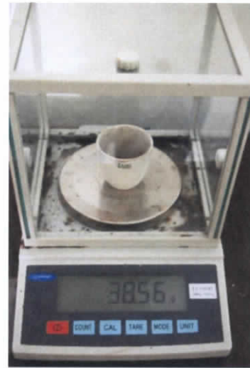
Figura 12.3.19. Registro del peso contante de los crisoles
