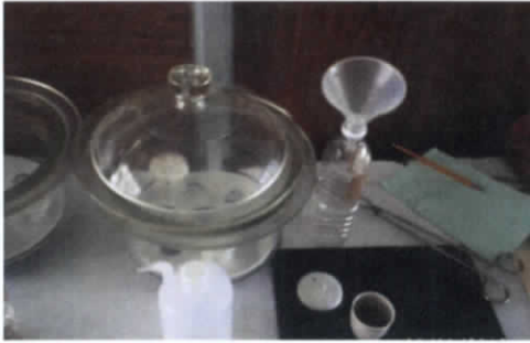
Figura 12.3.18. Enfriado de crisoles a temperatura ambiente dentro de desecador
