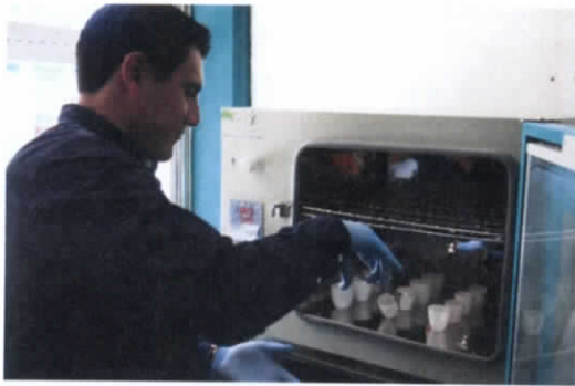
Figura 12.3.16. Limpieza de Crisoles a 500 °C
