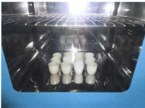
Figura 12.3.20. Secado de muestras en horno
