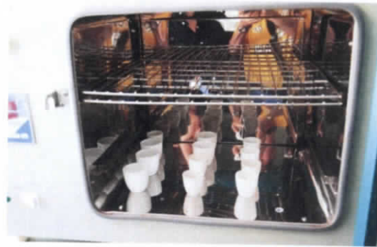
Figura 12.3.17. Limpieza de crisoles a 105 °C
