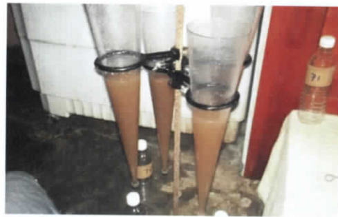
Figura 12.3.14 Obtención del volumen sedimentado mediante conos Imhoff
