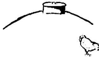
Figura 11.76. Pozo en donde la boca ha sido sellada con un cilindro y tapa. Fuente: HESPERIAN HEALTH GUIDES. 31
