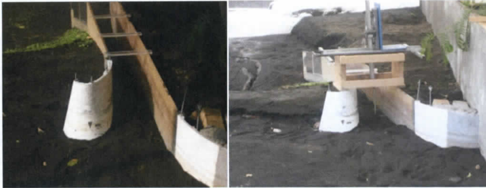
Figura 9.6 Vertedor de margen derecha instalada en el modelo físico
