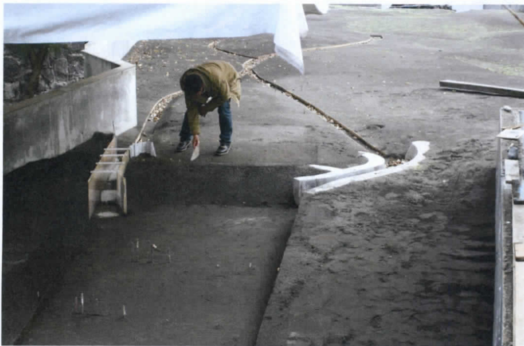
Figura 9.48 Configuración estructuras margen derecha e izquierda
