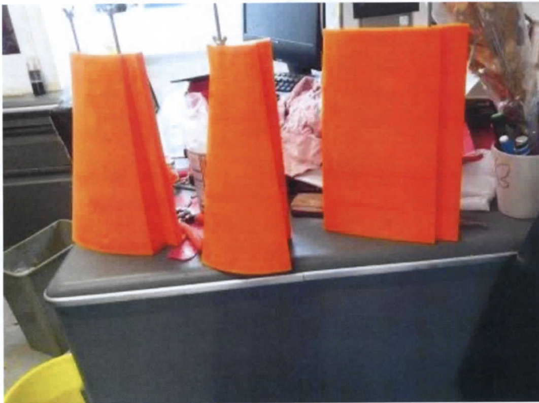
Figura 9.5 Elementos del vertedor de margen derecha fabricados con una impresora 3D
