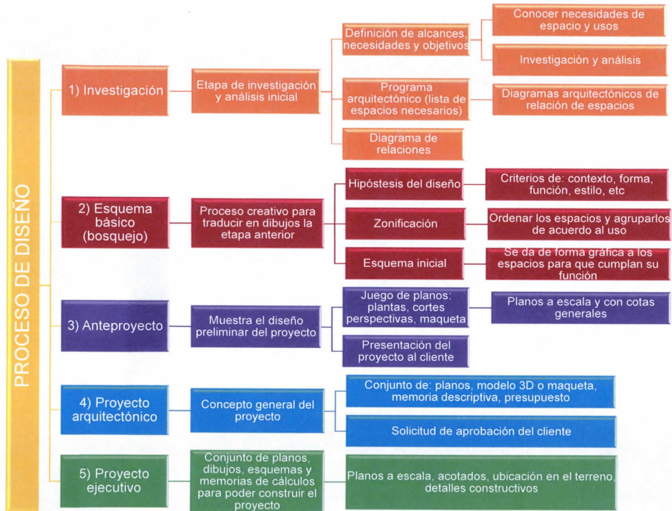
Figura 6.1.- Elementos del proceso de diseño arquitectónico
