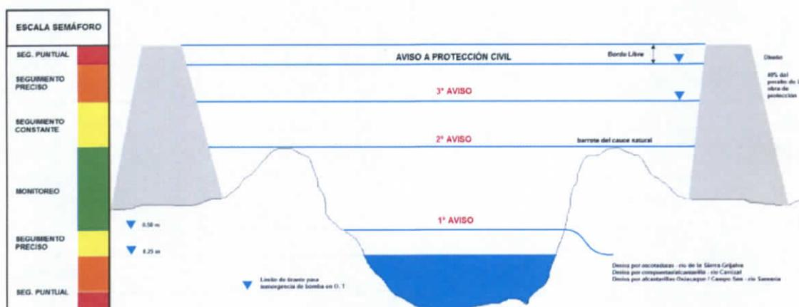
Figura 5.49.- Esquema Tipo – Sección tipo en planicie con obras de protección (FUENTE: CONAGUA, 2014)
