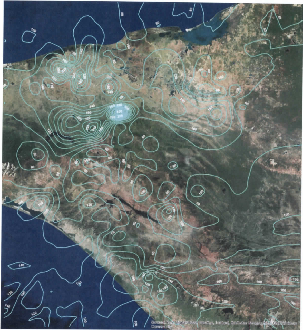
Figura 4.20.- Isoyetas generadas a partir de lluvias máximas del año 2011 (precipitación expresada en mm)
