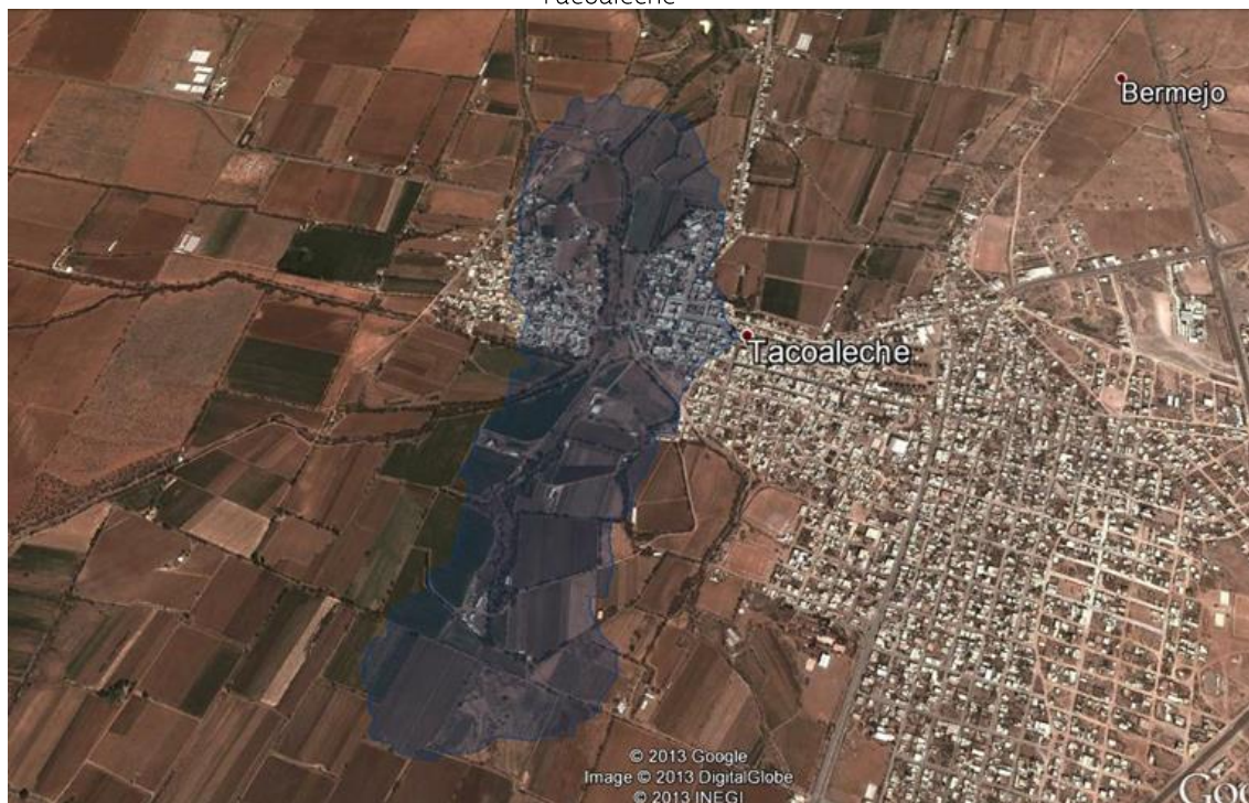
Figura 4-49 Polígono de Inundación asociado a un periodo de retorno de 2000 años, de la localidad de Tacoaleche
