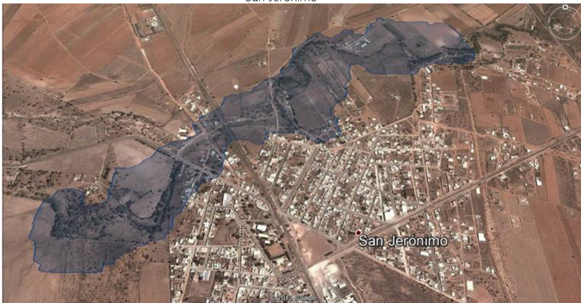
Figura 4-45 Polígono de Inundación asociado a un periodo de retorno de 2000 años, de la localidad de San Jerónimo
