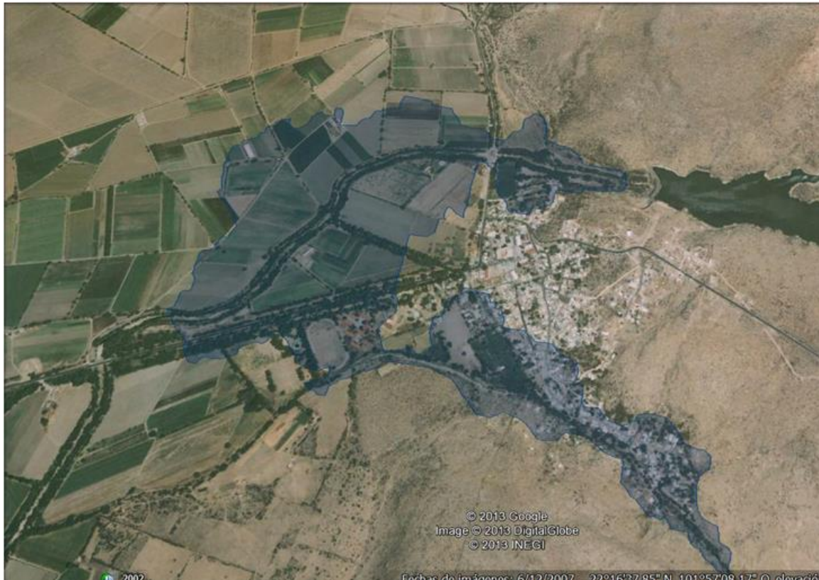
Figura 4-47 Polígono de Inundación asociado a un periodo de retorno de 2000 años, de la localidad de San Marcos
