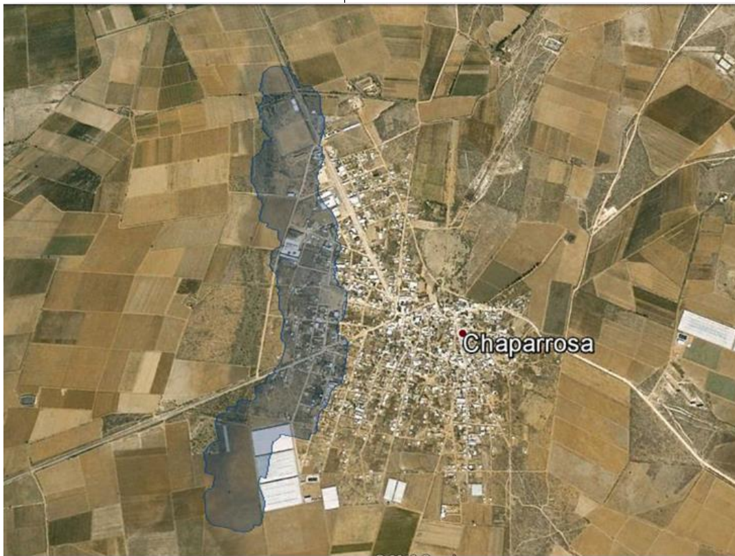
Figura 4-27 Polígono de Inundación asociado a un periodo de retorno de 2000 años, de la localidad de Chaparrosa
