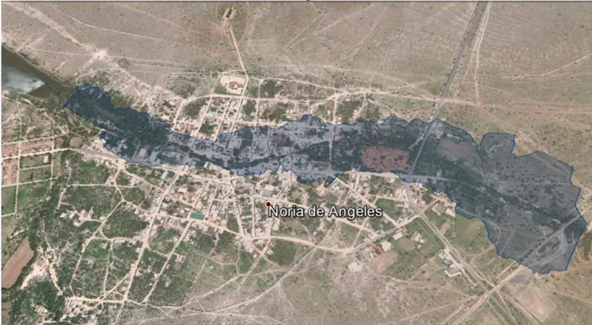
Figura 4-16 Polígono de Inundación asociado a un periodo de retorno de 2000 años, de la localidad de Noria de Ángeles
