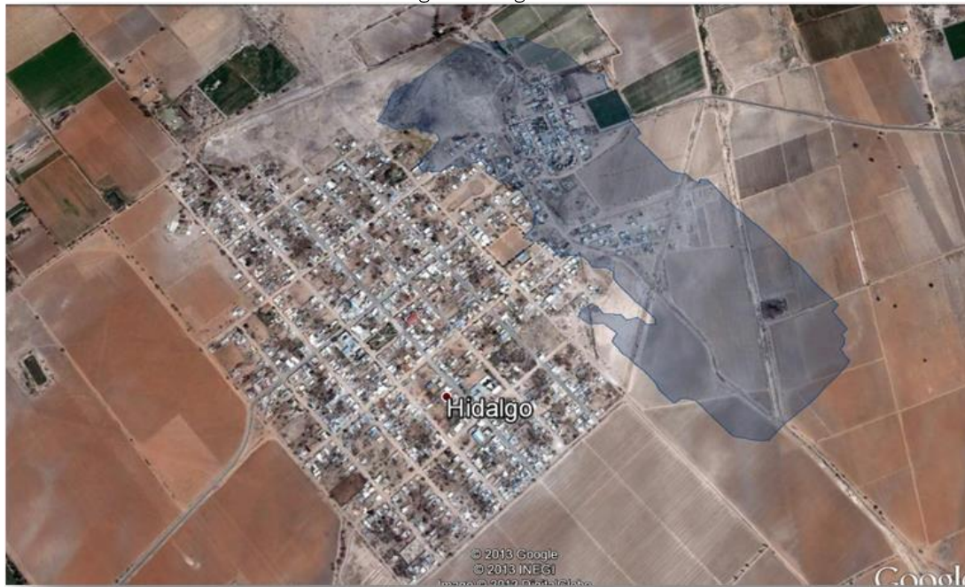
Figura 4-38 Polígono de Inundación asociado a un periodo de retorno de 2000 años, de la localidad de Miguel Hidalgo.
