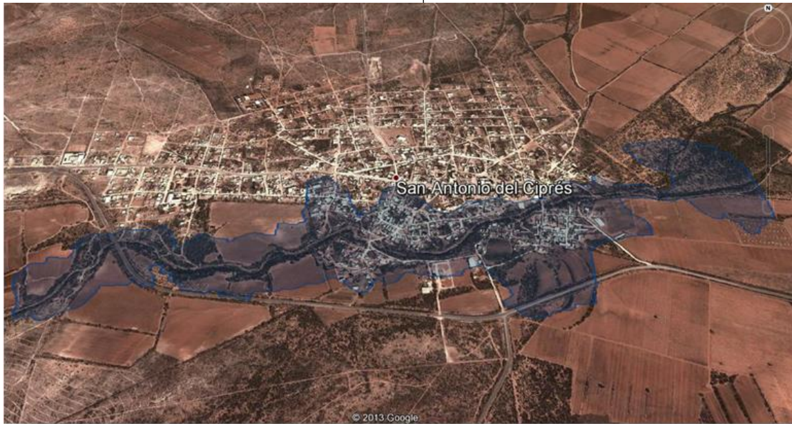
Figura 4-44 Polígono de Inundación asociado a un periodo de retorno de 2000 años, de la localidad de San Antonio Ciprés.
