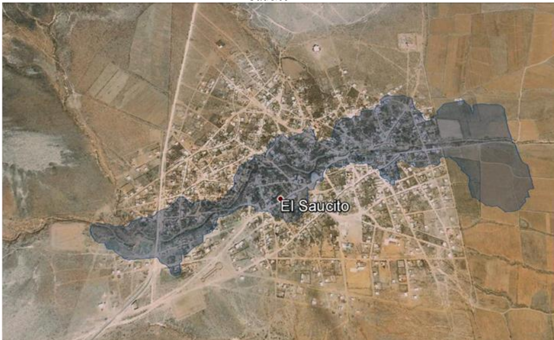
Figura 4-31 Polígono de Inundación asociado a un periodo de retorno de 2000 años, de la localidad de El Saucito
