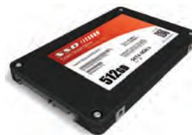
energía para funcionar y no tienen partes giratorias como en los discos duros tradicionales. Sus desventajas son el precio alto y las bajas capacidades de almacenamiento.
