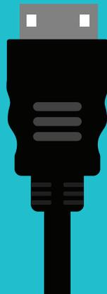
► **HDMI** (Interfaz Multimedia de Alta Definición). Es una conexión de audio-video diseñada especialmente para reproducir imágenes de video en alta definición (HD).
